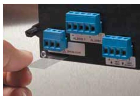
Enostavna instalacija napisne ploščice, prikazovalnika ni potrebo vzeti iz ohišja.
